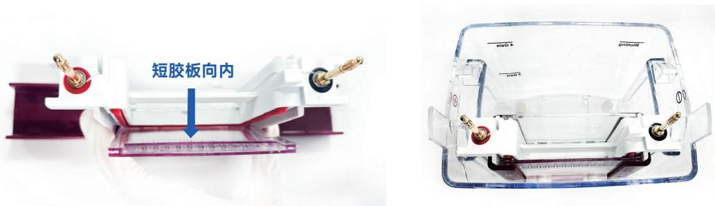
5. 向电泳槽的内槽中加入足量的 **1×Tris/MOPS/SDS 电泳缓冲液**, 浸没点样孔并使液面停留在其上方 5 mm 处, 接着在外槽中也加入足量的 **1×Tris/MOPS/SDS 电泳缓冲液**, 以确保电泳过程中适当的冷却效果;
