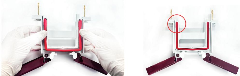
4. 按下图所示方法将预制胶安装到电泳装置中;
